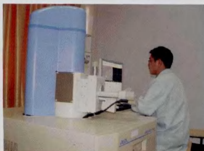
扫描电子显微镜 型号：JSM-6510LV
