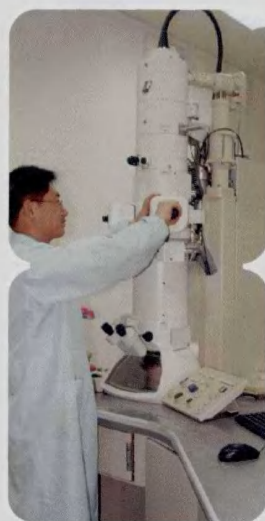
↑ 透射电子显微镜 型号：JEM 1400
