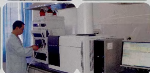
→ 高效液相色谱-飞行时间质谱联用仪 型号：1290 6224
