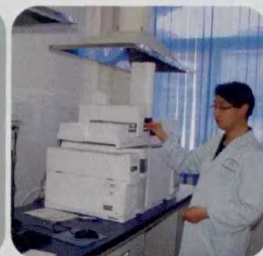
→ 气相色谱-质谱联用仪 型号：6890N-5975C
