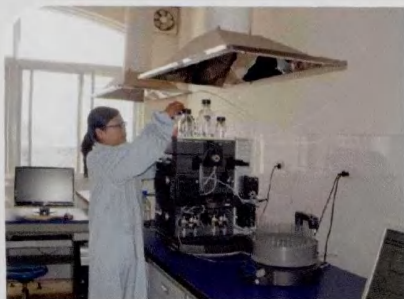
生物分子纯化工作站 型号：AKTA Purifier 100
